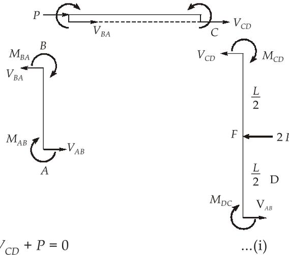
$$\Sigma f_x = 0 \Rightarrow V_{BA} + V_{CD} + P = 0$$
