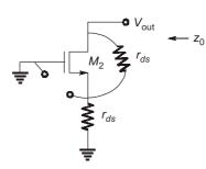
$$Z_0 = r_{ds} + r_{ds} + g_m r_{ds} r_{ds}$$
