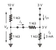
$$\frac{V_X - 10}{1 \text{k}\Omega} + \frac{V_X - 3}{1 \text{k}\Omega} + \frac{V_X}{1 \text{k}\Omega} = 0$$
