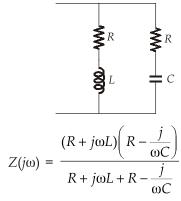
$$Z(j\omega) = \frac{(R+j\omega L)\left(R - \frac{j}{\omega C}\right)}{R+j\omega L + R - \frac{j}{\omega C}}$$
