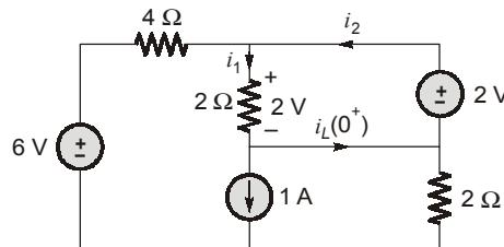
Here,  $i_1 = i_L(0^+) + 1 \text{ A} = \frac{2 \text{ V}}{2 \Omega} = 1 \text{ A}$
