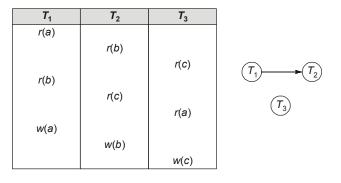
:. Conflict serializable schedule:  $T_3$ ,  $T_1$ ,  $T_2$ ,  $T_1$ ,  $T_3$ ,  $T_2$ ,  $T_1$ ,  $T_2$ ,  $T_3$
