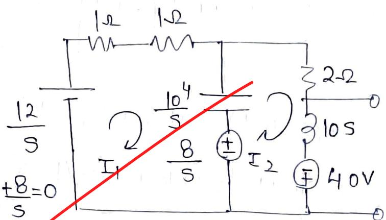
$$\text{i.e. } \left(2 + \frac{10^4}{s}\right) I_1(s) - \frac{10^4}{s} I_2(s) = \frac{4}{s} \quad \text{--- ①}$$
