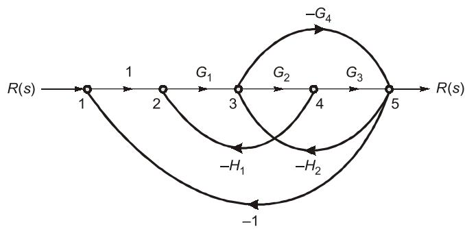
$$\frac{C}{R} = \frac{G_1 G_2 G_3 - G_1 G_4}{1+G_1 G_2 H_1 + G_2 G_3 H_2 + G_1 G_2 G_3 - G_1 G_4 - G_4 H_2}$$
