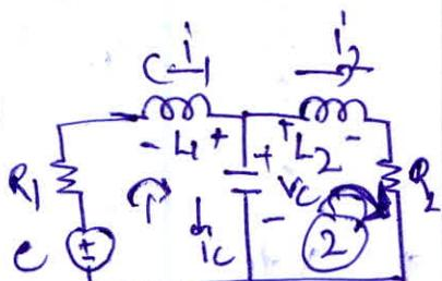
Now  $V_{L1} = i_1 R_1 + i_1 + i_2 = 0$
