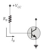
$$V_{CC} - I_B R_B - V_{BE} = 0$$
