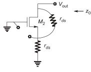
$$Z_0 = r_{ds} + r_{ds} + g_m r_{ds} r_{ds}$$
