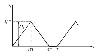
$$I_L^{\max} = \left(\frac{V_{\text{in}} - V_o}{L}\right) \cdot DT \qquad \dots (1)$$
