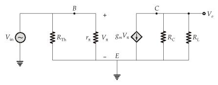
$$\begin{split} V_o &= -g_m (R_C \parallel R_L) V_{\pi} \\ &= -40.38 (4.7 \parallel 47) V_{\pi} \\ &= -172.533 V_{\pi} \end{split}$$
