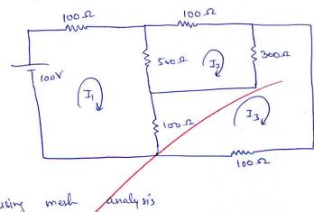
$$700T_1 - 500T_2 - 100T_3 = 100$$
