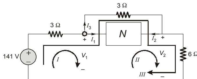
$$\begin{bmatrix} V_1 \\ V_2 \end{bmatrix} = \begin{bmatrix} 2 & 1 \\ 1 & 4 \end{bmatrix} \begin{bmatrix} I_1 \\ I_2 \end{bmatrix} \Rightarrow \begin{aligned} V_1 &= 2I_1 + I_2 \\ V_2 &= I_1 + 4I_2 \end{aligned}$$
