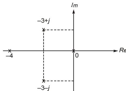
$$\phi = 90^\circ + 45^\circ + 161.565^\circ = 296.56^\circ$$
