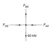
$$F_{BF} = 60 \, \text{kN} \, \text{(Tensile)}$$
