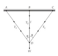
$$= \frac{T_2^2 l}{2AE} + \frac{(W - T_2)^2 l}{4AE\cos^3 \theta}$$
